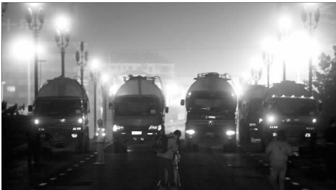
4辆30吨的槽罐试验车一字排开驶上大桥 快报记者 顾炜 摄
