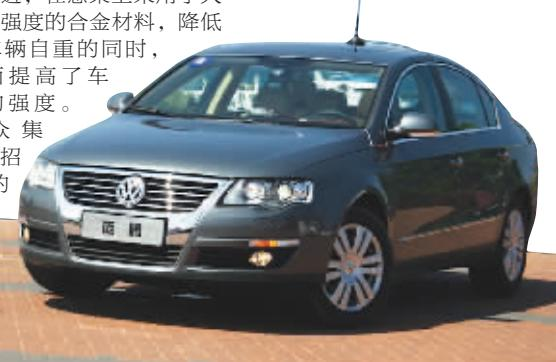
激光焊接技术在工艺上领先竞争对手,长达42米的无缝激光焊接构成了迈腾的主体结构。车身钢板热成形技术也是大众首次运用在这一级别的产品之上。在车身材料上,迈腾的整车用料79%采用了高强度钢材,车身强度增加了30%,令迈腾在欧洲NCAP碰撞测试中达到五星级标准。
