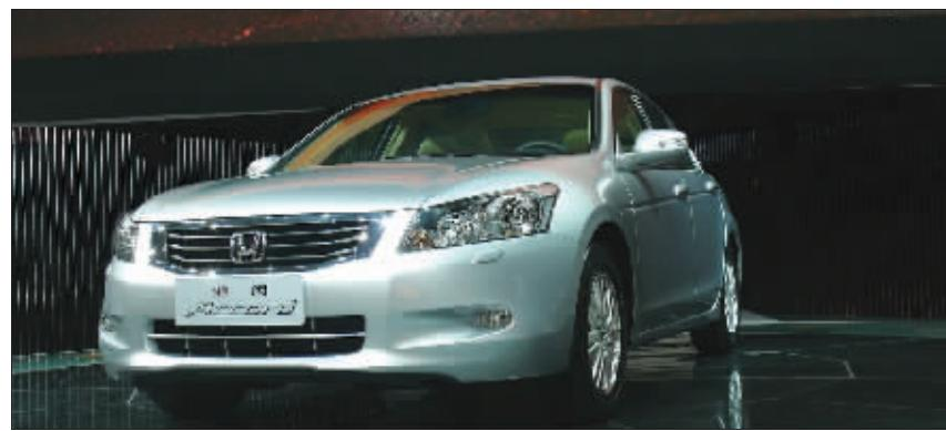
2008款雅阁三厢长为4930mm，比老款长了76mm，宽为1847mm，比老款宽了28mm，高度为1476mm，比老款高了23mm。轴距长度为2799mm，比老款车型长61mm。虽然车身尺寸加大，但是由于48%的车身使用了高延展性钢材，整车的抗扭能力增加了20%。先进的车身结构使得整车刚性大大提升、尺寸增大的情况下，重量只增加了5%。雅阁Coupe车型的长宽高分别为4844mm, 1847mm, 1415mm。轴距为2741mm。
