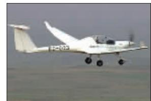
称,这架氢气电池飞机的飞行时间可达45分钟,起飞时仍须靠其他电池提供辅助动力,但是在空中飞行时就完全靠氢气电池。
