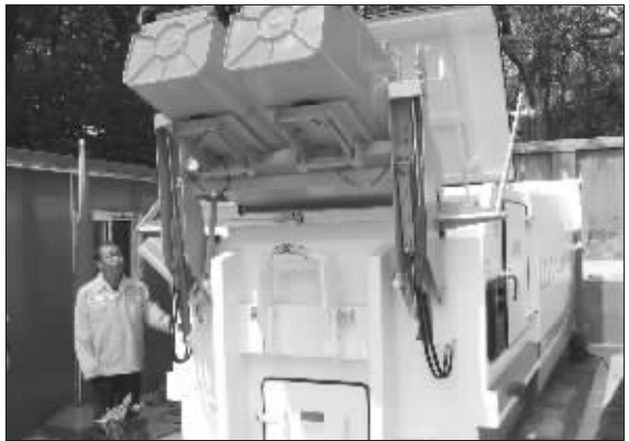
压缩箱正在“吞”垃圾 通讯员 杨诚刚 摄
