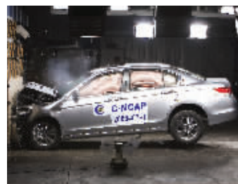
正面100%重叠刚性壁障碰撞实验
