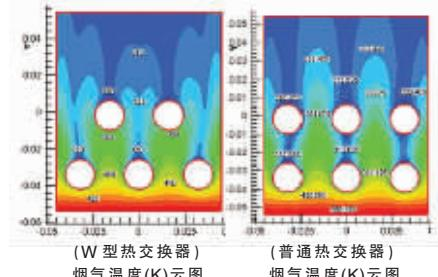
方太“W”宽频节能热水器的最大成果是在普通燃气热水器的热交换器基础上进行技术改进，外观看上去没有差别，但是热效率比普通燃气热水器提高了8%左右。而目前市场上出现的冷凝式热水器，热效率虽然比较高，但存在冷凝水的排放，一般家庭不便于安装，“W”宽频燃气热水器的安装方式和普通的燃气热水器安装方式没有差异，所以它是一项更容易推广的节能成果。
