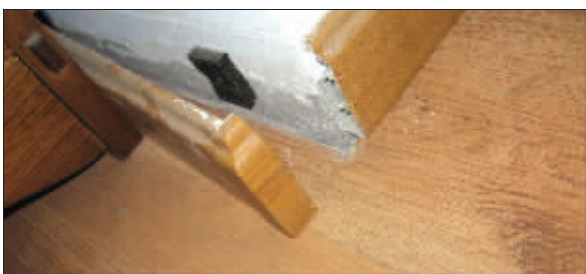
专家撬开主卧门前一踢脚线测量水泥地板湿度
