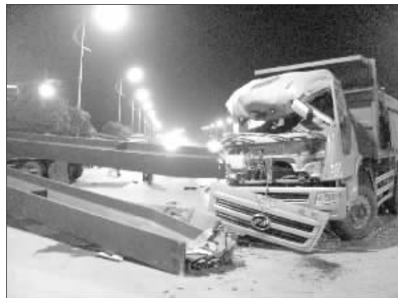
工字梁戳穿驾驶室
