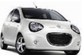
熊猫采用大量中国元素进行设计,凭借“仿生设计”、“卓越安全”、“外小内大”、“充沛动力”等设计,将成为市场上最抢眼的明星之一。采用1.3升中英技术合作发动机并采用了双顶置凸轮轴、多点电喷技术,最大功率达到63kW,最大扭矩110Nm,最高车速达到了165km/h。并使用同级车中少见的八通路六气囊加侧气帘设计。而安全就是吉利熊猫有别于同类小型车高附加值的
