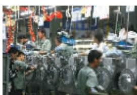
一走进洗衣机工厂的生产基地，营员就被LG生产规模的浩大以及生产线上线下的整齐划一震住了。据生产部负责人宗华介绍，南京的LG洗衣机生产线一共有四条，三条是普通产品线，一条是专门的高端产品线，囊括了波轮和滚筒两类产品，每条生产线上不仅肩负着生产的任务，还配备了噪音检测、漏水检测以及2小时一次的开箱检测环节，所有检测都与生产同时进行。
