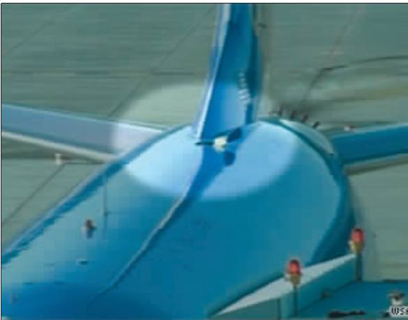
机身上的裂口导致机舱内失压
