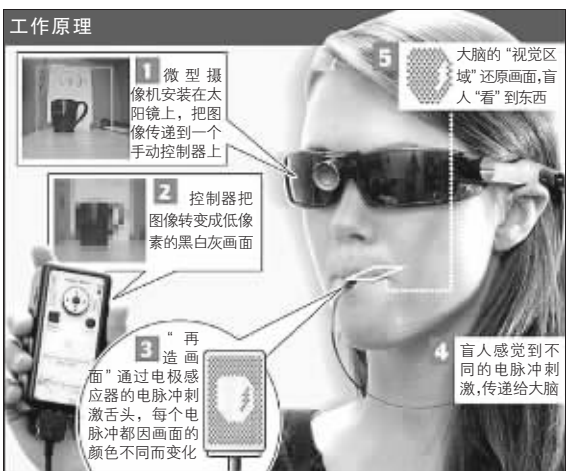
“电子棒棒糖”帮助盲人用舌头“视物”示意图
