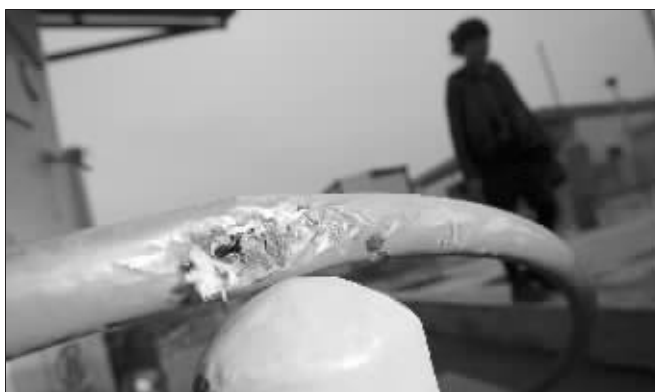
输气软管炸开一道近10厘米长的口子 快报记者 辛一摄
