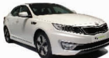
110kW/6000rp 和 35kW/1630~3000rpm。同时该车采用锂离子高性能蓄电池。K5混合动力还搭载了6速手自一体变速箱。
