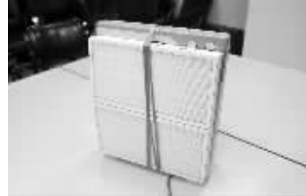
用宽布条将过滤网固定到风扇正面
