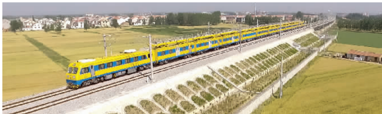
技术人员利用检修列车,验收接触网供电设备 通讯员 梁明哲 摄
