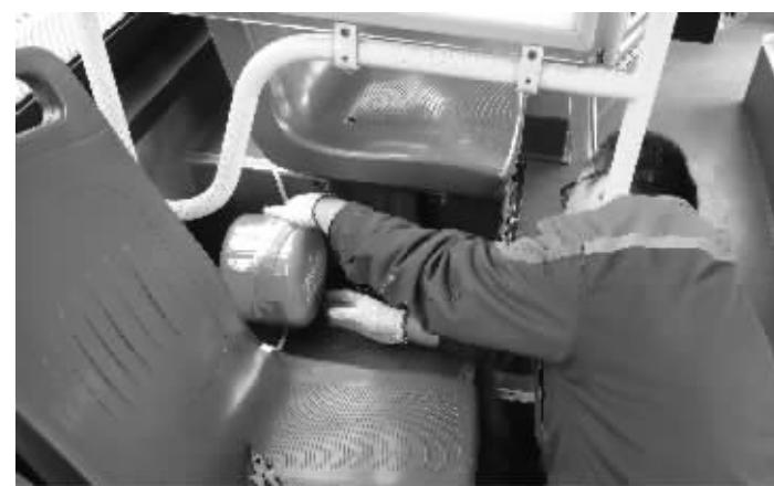
的覆盖面积为直径5米左右,一辆8米长的公交车只需装载两枚就可以了,灭火弹在接触火源3至5秒后会立即启动,使火灾被控制在萌芽状态,而且溅出的泡沫不含毒害成分,不会对乘客造成伤害,同时还能防止公交车复燃。
